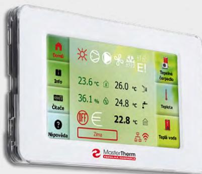
Terminál pGDx se 4,3palcovou dotykovou obrazovkou a vlastním procesorem je hlavním ovládacím panelem tepelného čerpadla. S jeho pomocí lze snadno nastavovat požadovanou vnitřní teplotu a všechny další funkce čerpadla. Integruje v sobě funkci prostorového přístroje k řízení teploty vytápěného/chlazeného prostoru. K terminálu je možné přiřadit řídicí panely nebo teplotní čidla vedlejších topných okruhů a vše ovládat z jednoho místa.
